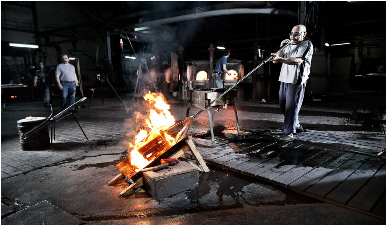
Bild: Produktion mundgeblasenes Fensterglas, © Glashütte Lamberts Waldsassen, www.lamberts.de
