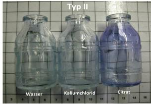
Abb. 4: Typ II-Flaschen behandelt mit verschiedenen Medien mit durch Methylblau visualisierbarer Korrosion
