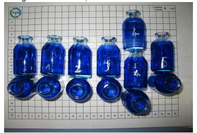
Typ III-Flaschen mit durch Methylblau visualisierbarer Korrosion
