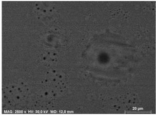
Abb. 2: REM-Aufnahme der beschädigten Oberfläche einer Typ II-Flasche
