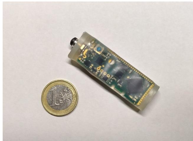
Abb. 2: Datenlogger „MSR175B4“ im Größenvergleich zu einer 1-Euro-Münze
