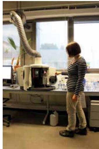
*In der ICP-OES werden Glasproben bei Temperaturen wie auf der Sonne im Plasma untersucht.*
